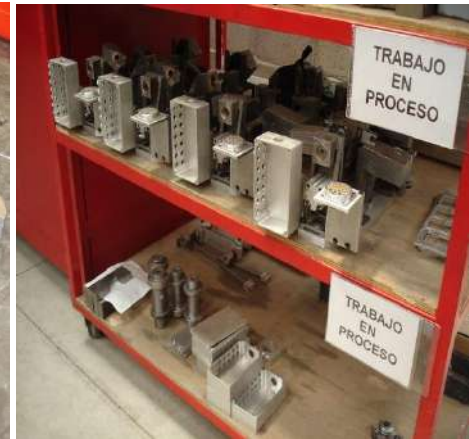
Dispositivos de soldadura
